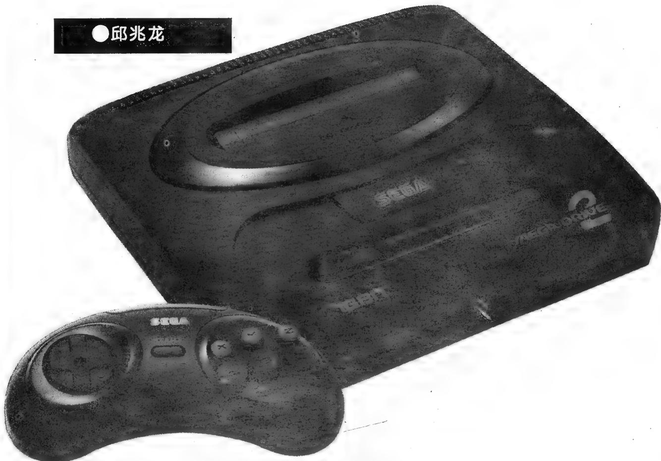
1988年家用游戏机制造业又掀起一次大革命。任天堂的“红白机”统治此一方热土已有五年了，市场占有率达97%，其间NEC推出的一系列PC—E游戏机对“红白机”的统治产生一定影响，但并没有从根本上动摇“红白机”的霸主地位。而在1988年10月29日，由任天堂的最大对手世嘉推出的16位游戏机“兆位驱动”(MEGA DRIVE)从根本上动摇了“红白机”的地位，该机使用MOTOROLA公司的MC68000和一个专门用来处理音乐的Z80作CPU，是世界上第一个使用双CPU的游戏机，MD充分显示了16位机的优越性，背景卷轴有2个，可显示512彩色，画面立体感非常强，直接存储量有4096K，特别突出的是MD的音响效果，世嘉在MD上加上一个立体声耳机输出，游戏机者在玩游戏的同时如接出一个耳机或一个音箱就能欣赏到MD软件中高质量的音乐。几乎每一家为世嘉开发游
